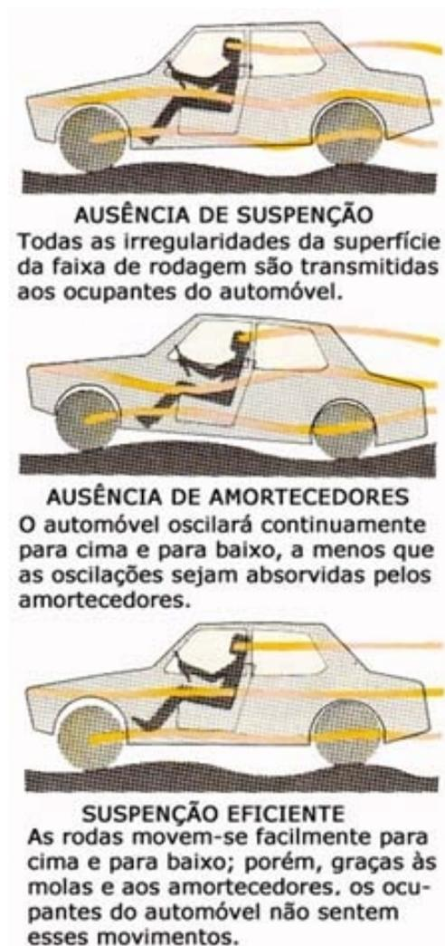
*Figura 16: Princípio de funcionamento da suspensão.*
