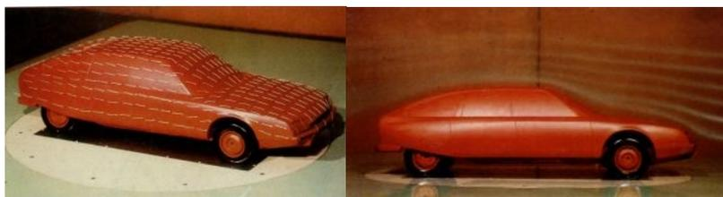
Figura 29: Mecanismos para visualização do escoamento.
