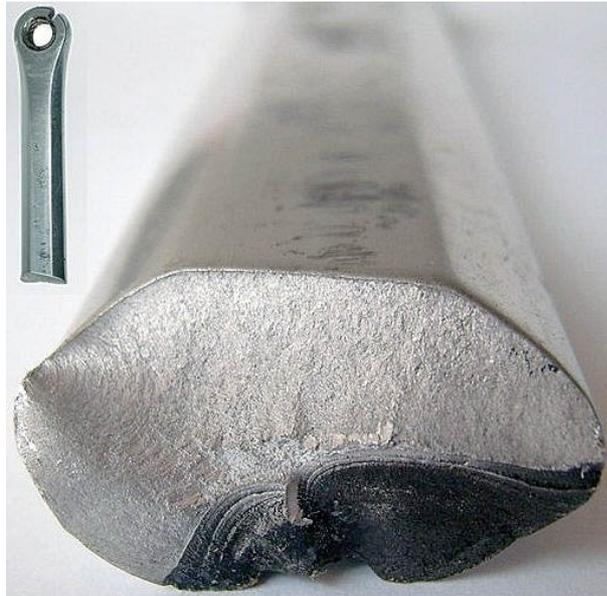
*Figura 33: Exemplo de fratura por fadiga.*
