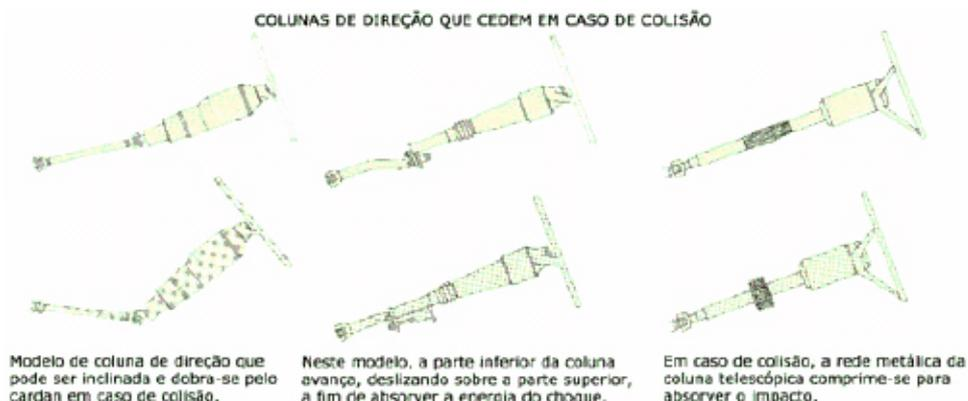
Figura 23: Esquemas de direções seguras em casos de colisão frontal.
